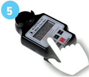
5) Appuyer à nouveau sur le bouton «TESTER» afin d'afficher la différence de conductivité électrique (DIF). La différence est calculée à partir de la valeur la plus basse.
